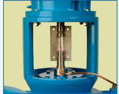
Accouplement rigide divisé: En retirant les boulons de l'accouplement, la moitié du manchon d'accouplement est enlevé pour exposer les arbres du moteur et de la pompe avec leurs clés.
