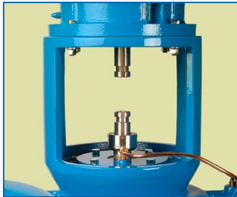
Scellé mécanique prêt à enlever: Après avoir désaccouplé la ligne de recirculation, le scellé mécanique peut être retiré facilement et remplacé grâce à l'espace disponible entre les arbres du moteur et de la pompe.
